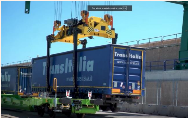
Carga de un remolque de camión en la estructura de un tren
